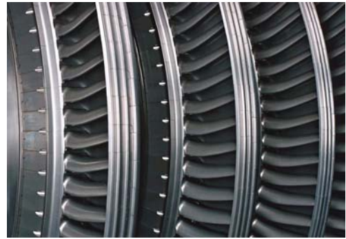
実機中圧部に採用されたAFP動翼
